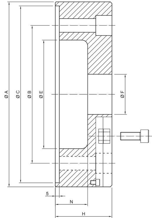
Mandrino per testa principale (Main spindle) o controtesta (Sub spindle) di torni dotati di cilindro posteriore. Può montare pinze espansibili tipo PE-PET, a cuspidi ecc., semplicemente sostituendo dgli appositi adattatori.
